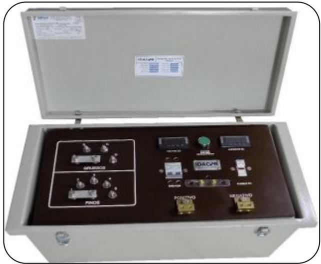
Rectificador de corriente con múltiples salidas DC (hasta 5 salidas) positivo, negativo, breaker, puente de diodos y selector de taps independientes. Ideales para patios de tanques.
